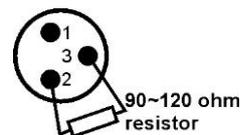
Um ein merkwürdiges Verhalten der Lichteffekte durch Störungen zu verhindern, müssen Sie die Kette mit einem 90  $\Omega$  bis 120  $\Omega$  Abschlusswiderstand am Ende abschließen. Verwenden Sie niemals Y-Splitter-Kabel, das funktioniert einfach nicht!
