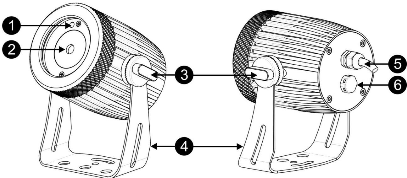
1. **IR-EMPFÄNGER:** Empfängt die Befehle von der IR-4 Fernbedienung.
