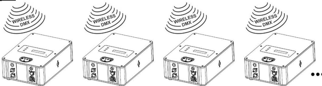
**OPTION 2 :** Sans fil avec enchaînement en cascade à l'aide de câbles DMX (peut être mélangé avec tout autre appareil contrôlé par DMX).
