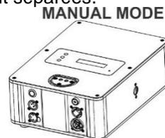
**OPTION 2 :** Réglage manuel sur la première unité avec enchaînement en cascade à l'aide de câbles DMX (les autres unités doivent fonctionner en mode **XLR IN XLR OUT** avec l'adresse DMX réglée sur 001.
