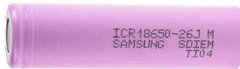
3. Inserte la batería (**modelo: 18650 \* 3,7V Li-ion**) en la ranura. Preste atención a la dirección correcta y la polaridad.
