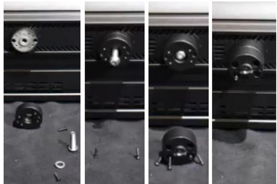
9. Placez les 2 rondelles en cuivre sur le côté droit du projecteur et pressez les 2 rondelles en cuivre avec le cylindre "B" (avec le trou de 10 mm).
