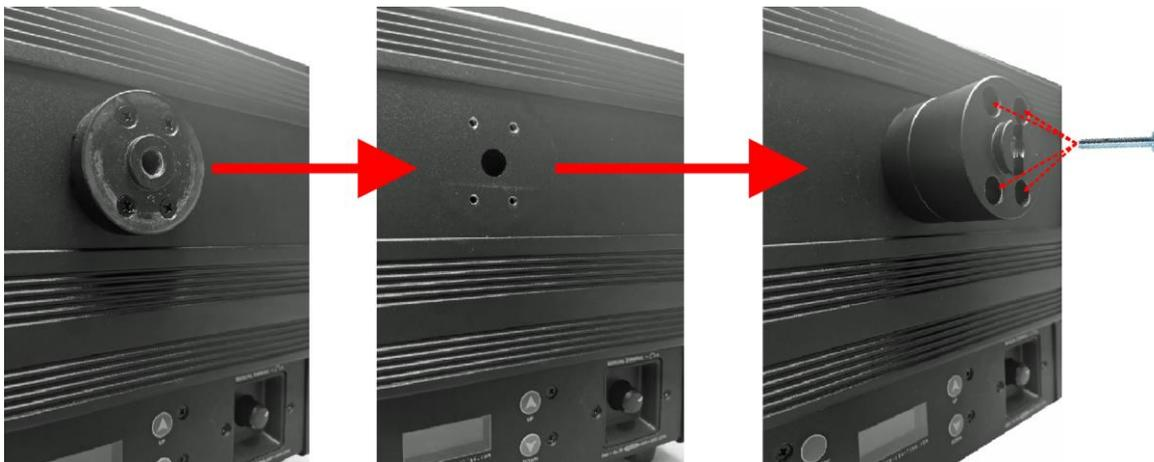
5. Befestigen Sie stattdessen den neuen Aluminiumzylinder aus dem BT-THEATRE YOKE und den Kunststoffzylinder aus dem ADAPTER-2-Set auf beiden Seiten des Projektors. Verwenden Sie dazu die 8 neuen M4-Schrauben, die im ADAPTER-2-Set enthalten sind.
