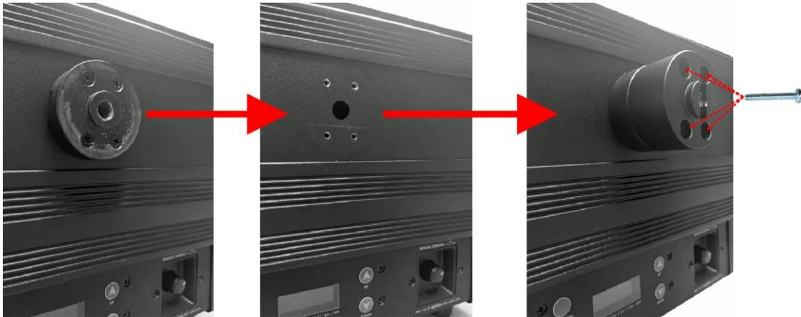
5. Fixez à la place le nouveau cylindre en aluminium du BT-THEATRE YOKE et le cylindre en nylon du kit ADAPTER-2 des deux côtés du projecteur. Pour ce faire, utilisez les 8 nouveaux boulons M4 fournis avec le kit ADAPTER-2
