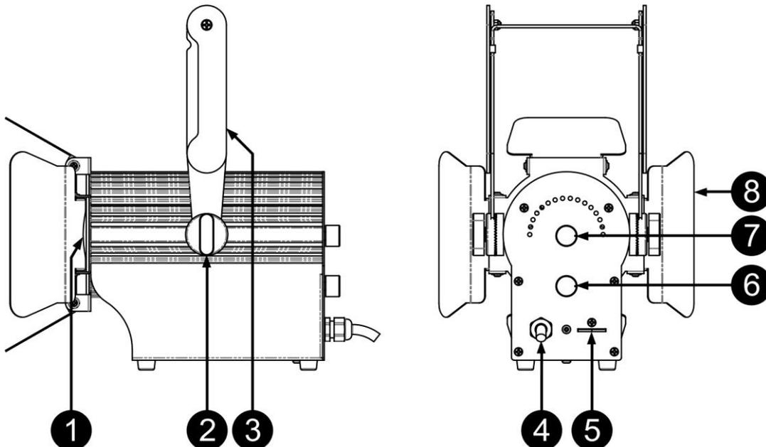
1. **PORTAFILTROS MAGNÉTICO:** para sujetar diferentes tipos de filtros con un diámetro de 7cm.
