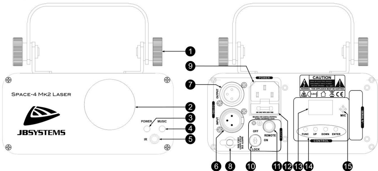
1. **SUPPORT DE SUSPENSION** Support de suspension avec 2 boutons sur les deux côtés pour attacher l'appareil et un trou de montage pour un crochet de fixation.
