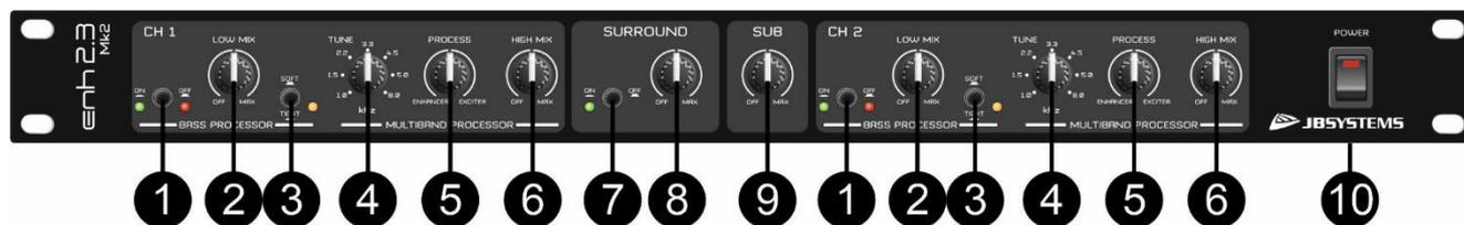
1. **Interrupteur ON/OFF du canal** : Ce bouton permet de faire basculer le processeur entre le fonctionnement (voyant vert allumé) et le bypass (voyant rouge allumé). Vous pouvez utiliser cet interrupteur pour comparer le son avec et sans traitement. Il est ainsi plus facile de régler le son en procédant par essais et erreurs.
