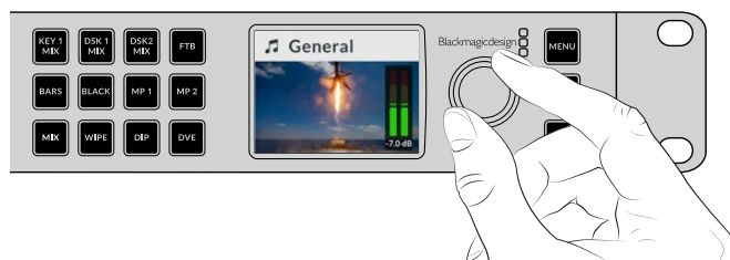
Al ajustar el volumen mediante el mando giratorio en el panel frontal, dicho cambio se verá reflejado en los vúmetros de la pantalla.
