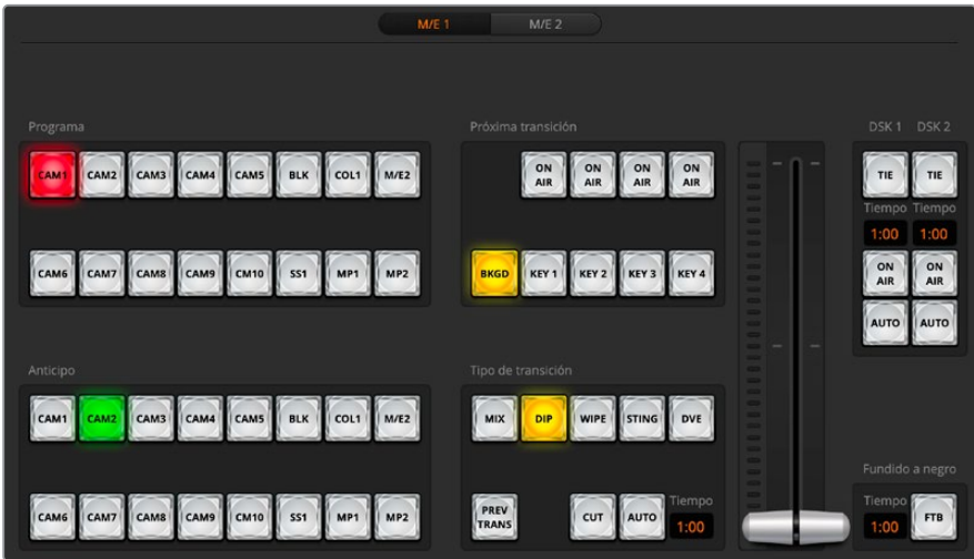
En los modelos ATEM 2 M/E, 4 M/E y 8K, seleccione el banco de mezcla y efectos mediante los botones numerados en la parte superior de la interfaz.
