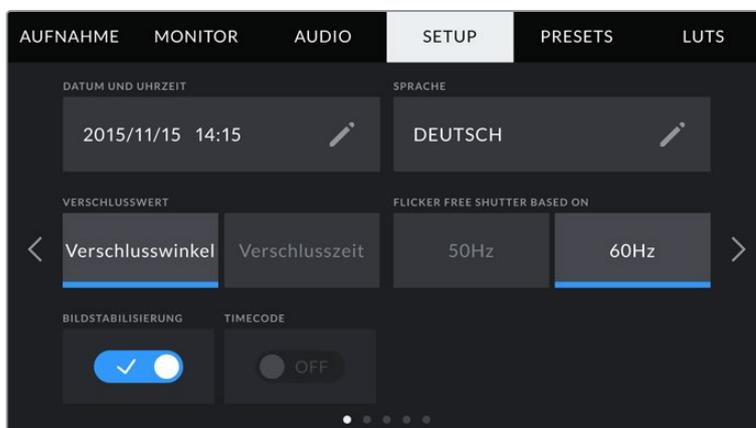
Bei der Pocket Cinema Camera 4K bietet die erste Seite des SETUP-Tabs die Option „Bildstabilisierung“ zum Einschalten der Bildstabilisierung für Ihr Micro-Four-Thirds-Objektiv
