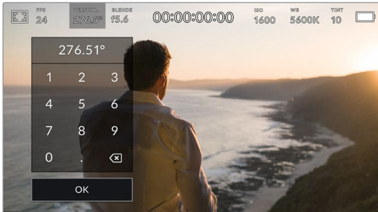
Geben Sie den Verschlusswinkel manuell über die kleine Tastatur ein, wenn Sie im Freien oder bei flimmerfreiem Licht drehen
