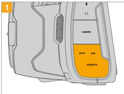
Öffnen Sie die Gummiabdeckung auf der linken Seite der Kamera und stecken Sie das andere Ende des Kabels in den USB-C-Port.
