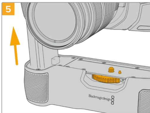
Führen Sie den akkuförmigen Teil des Akkugriffs in das Akkufach Ihrer Kamera ein. Die 1/4-Zoll-Schraube an der Oberseite des Akkugriffs sollte dabei auf das 1/4-Zoll-20-Befestigungsgewinde am Kameraboden ausgerichtet werden. Ein kleiner Stift neben der 1/4-Zoll-Schraube erleichtert die Ausrichtung.
