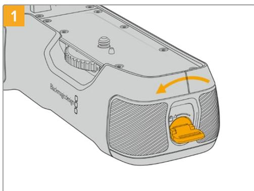
Drehen Sie die Verriegelungslasche an der rechten Seite des Akkugriffs gegen den Uhrzeigersinn, um ihn zu entriegeln. Ziehen Sie den Akkueinschub heraus. Dies ist möglich, bevor oder nachdem Sie den Akkugriff an Ihre Kamera angebracht haben.
