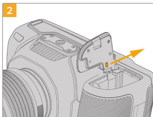
Schieben Sie den Schieber am Scharnier der Akkufachabdeckung in Richtung Kamerarücken und nehmen Sie die Abdeckung von der Kamera ab.
