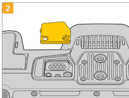
Entfernen Sie die Abdeckung vom Kameraboden. Nun liegen die elektrischen Kontakte frei, die den Strom aus den Akkus im Griff weiterleiten.
