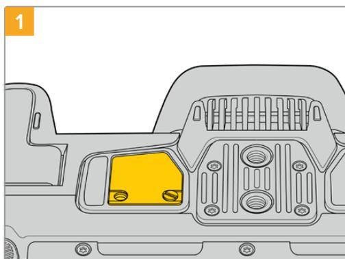
An der Unterseite der Kamera finden Sie neben dem Akkufach eine kleine Abdeckung. Lösen Sie die Befestigungsschrauben der Abdeckung.
