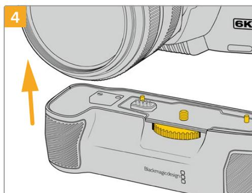
Drücken Sie den Kameragriff vorsichtig an den Boden Ihrer Kamera. Richten Sie die 1/4-Zoll-Schraube oben am Akkugriff auf das 1/4-Zoll-20-Befestigungsgewinde am Kameraboden aus. Die kleinen Stifte beiderseits der 1/4-Zoll-Schraube helfen mit der korrekten Ausrichtung.
