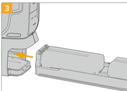
Führen Sie den Akkuträger in den Akkugriff ein und drehen die Verriegelungslasche im Uhrzeigersinn. Wird Ihre Kamera über einen DC-Stromanschluss mit externem Strom versorgt, können Sie auch während eines Akkuwechsels weiterfilmen.
