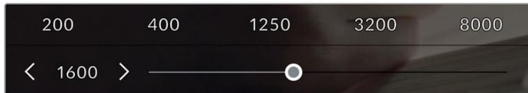
Bei geöffnetem ISO-Menü erscheinen die ISO-Einstellungen Ihrer Kamera am unteren Rand des LCD-Touchscreens. Mit dem Schieberegler unter den Presets können Sie den ISO-Wert in Drittel-Blendenstufen anpassen
