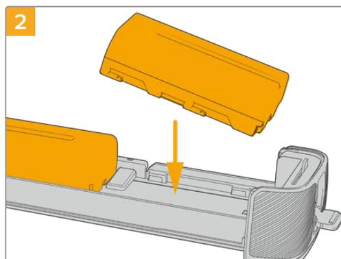
Legen Sie zwei NP-F570-Akkus unter Beachtung ihrer korrekten Ausrichtung in den Akkueinschub ein und schieben Sie sie voneinander weg. Zwischen den beiden Akkus springt ein Sperrknopf nach oben, woraufhin die Akkus einrasten. Zum Herausnehmen der Akkus drücken Sie auf den Sperrknopf und schieben die Akkus wieder aufeinander zu.
