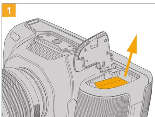
Öffnen Sie das Akkufach der Kamera und entnehmen Sie den LP-E6-Akku.
