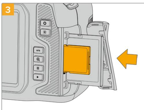
Halten Sie die SD-Karte mit der Beschriftung zum Touchscreen hingewandt und schieben Sie sie in den SD-Kartenschacht, bis sie spürbar einrastet. Die Karte sollte sich ohne übermäßigen Kraftaufwand einführen lassen. Um die SD-Karte zu entfernen und auszuwerfen, schieben Sie sie sanft in die Kamera.
