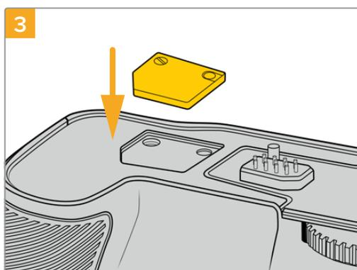
Schieben Sie die Kameraboden-Abdeckung mit den Kontakten zur sicheren Verwahrung in das Fach oben am Akkugriff. Sichern Sie die Abdeckung durch Anziehen der Schraube.
