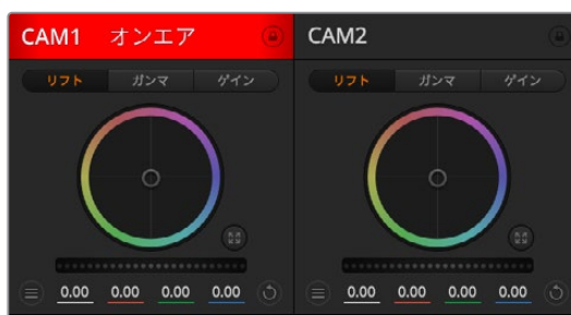
各カメラコントロールにチャンネルの状況が表示されるので、オンエア中のカメラが確認できます。カラーホイールを使用して、各YRGBチャンネルのリフト、ガンマ、ゲイン設定を調整します。
