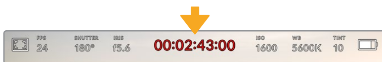
El tiempo de grabación se muestra en rojo cuando la cámara está grabando.
