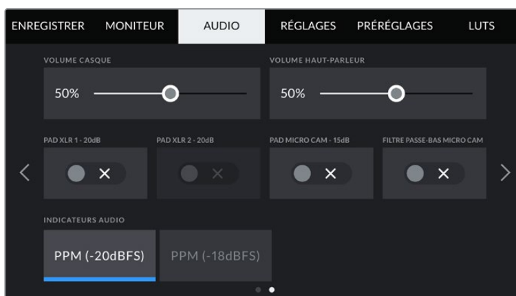
Paramètre Audio meters sur la URSA Mini Pro 12K et la URSA Mini Pro G1
