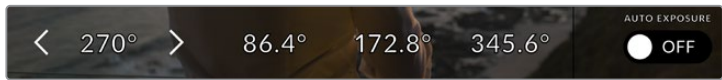
URSA Mini는 설정(SETUP) 메뉴에서 선택한 주전력 주파수를 기반으로 플리커 현상이 없는 셔터 개각도를 제시합니다.
