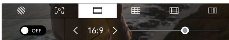
Toque no ícone das guias de enquadramento nas opções de monitoramento LCD para acessar suas configurações na URSA Mini.
