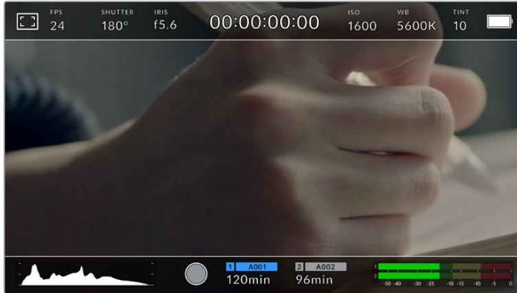
URSA Mini的LCD触摸屏启用2.40:1帧导栏设置后的显示。
