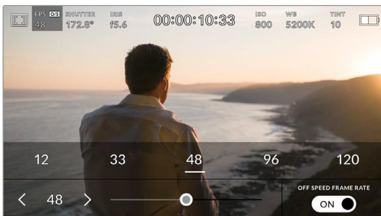
Lorsque le bouton **Off speed frame rate** est activé, touchez les flèches situées de part et d'autre de la fréquence d'images du capteur, déplacez le curseur, ou touchez un des pré-réglages pour configurer le paramètre.
