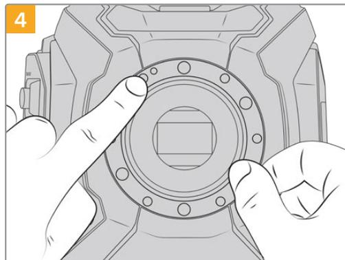
Notez que la rondelle de 0,50mm est alignée avec le goujon d'assemblage à la position de 11 heures.
