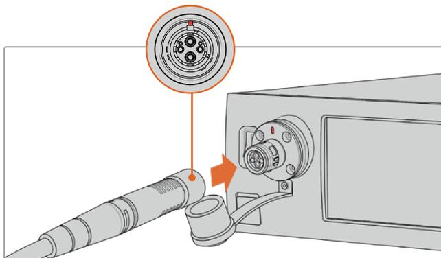
Branchez l'extrémité mâle du câble fibre SMPTE au connecteur femelle situé à l'avant du Blackmagic Studio Fiber Converter
