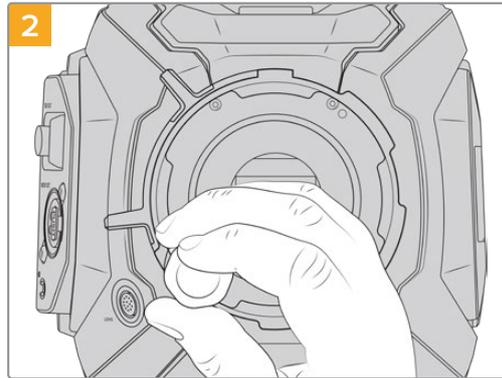
Retirez les six vis de la monture PL à l'aide du tournevis 2,0mm. Vous devrez peut-être faire tourner la bague de verrouillage PL de temps en temps dans le sens des aiguilles d'une montre ou dans le sens contraire pour accéder aux vis.
