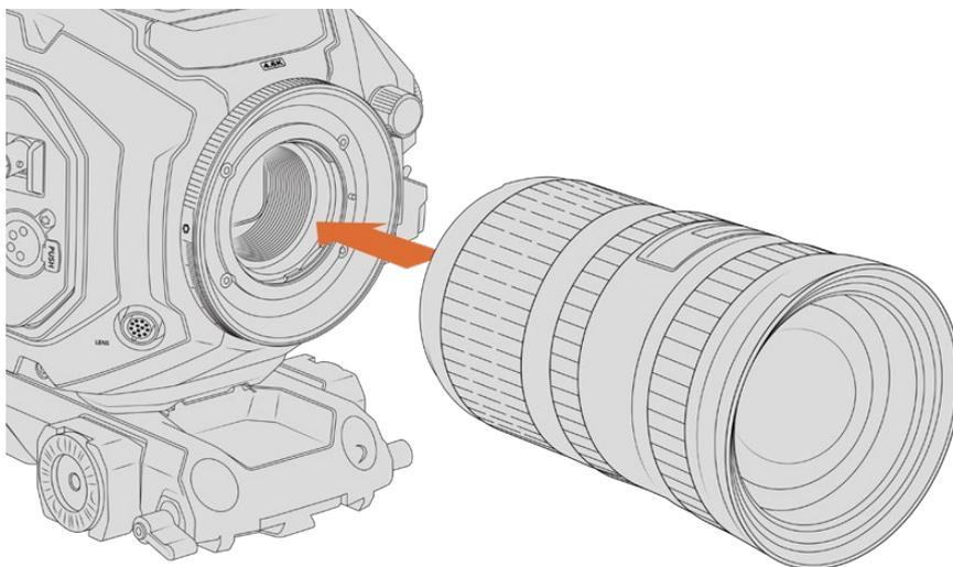
Fixer et retirer un objectif à monture F sur la Blackmagic URSA Mini Pro 4.6K dotée de la monture F en option.
