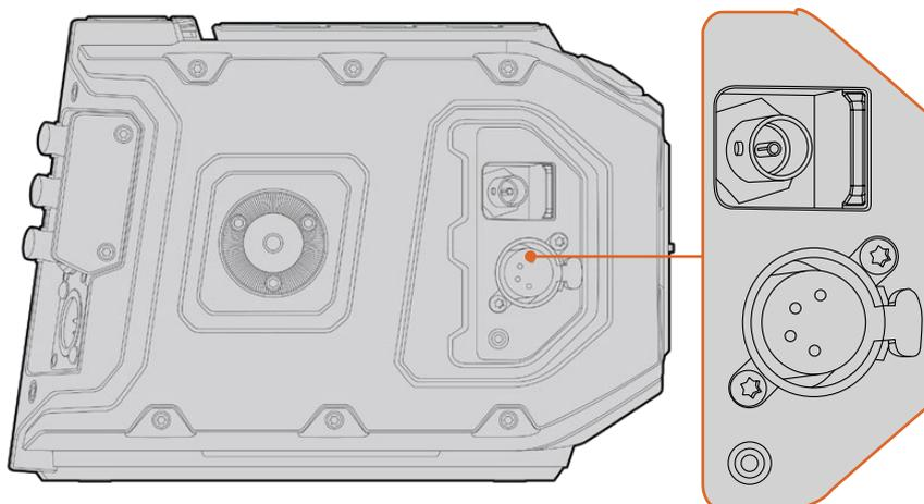
Connectez le câble SDI et le câble d'alimentation du viseur à la sortie de monitoring HD-SDI et à la sortie +12V de la caméra URSA Mini.
