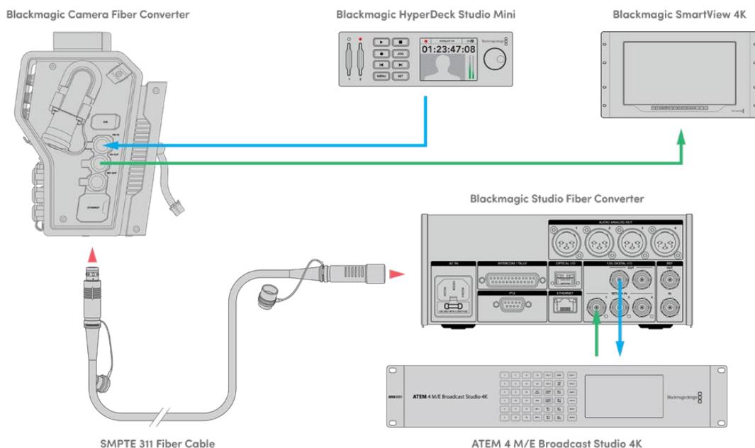
Pour confirmer la vidéo, branchez les sources vidéo sur les entrées des voies de retour du Studio Converter, puis visualisez-les sur un moniteur connecté au Camera Converter.
