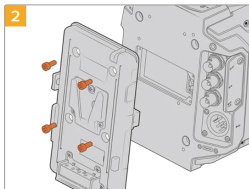
Retirez les éventuelles fixations pour batteries de votre caméra. Pour plus d'informations sur le montage et le démontage des fixations pour batteries, veuillez consulter la section « Fixer des batteries » de ce manuel.
