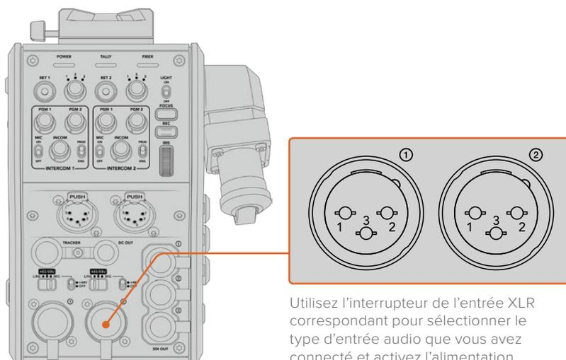
Utilisez l'interrupteur de l'entrée XLR correspondant pour sélectionner le type d'entrée audio que vous avez connecté et activez l'alimentation fantôme si nécessaire
