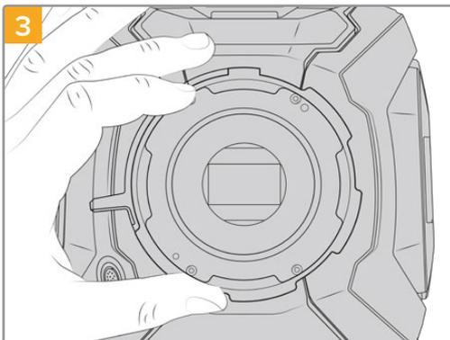
Soulevez délicatement la monture d'objectif pour la séparer du boîtier de la caméra. Gardez les vis à proximité de la monture d'objectif.
