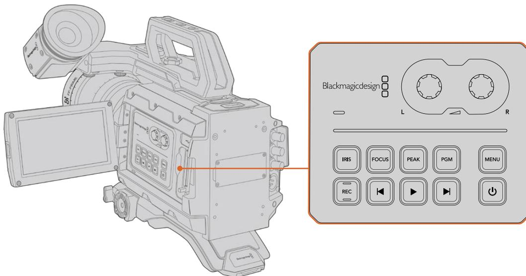
Réglez les paramètres de la caméra à l'aide des boutons du panneau de contrôle et de l'écran tactile
