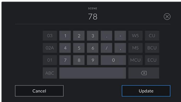
Lorsque vous saisissez les métadonnées de la scène, la URSA Mini proposera des incréments sur le côté gauche du clavier tactile, et des types de plans sur le côté droit.
