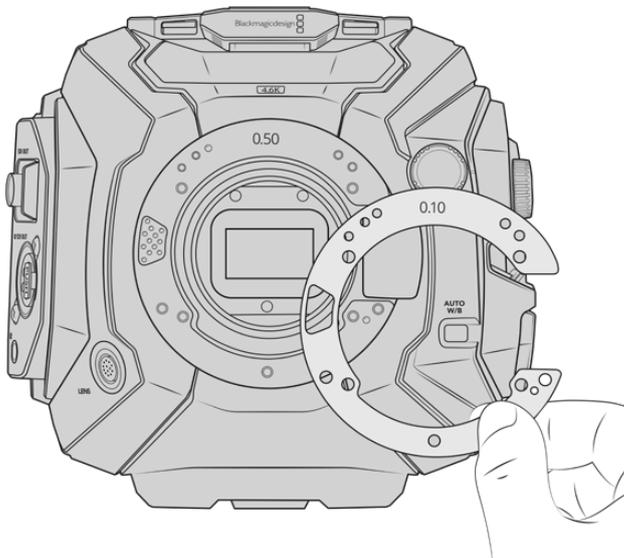
Les rondelles de la URSA Mini Pro sont en forme de C, ce qui permet d'éjecter plus facilement les objectifs d'une monture EF. Les rondelles sont ainsi plus faciles à aligner car elles ne peuvent rentrer que dans un sens. Mise à part la forme des rondelles, le calage des montures est identique à celui de la URSA Mini PL.
