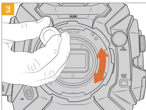
À l'aide d'un tournevis hexadécimal 2mm ou d'une clé dynamométrique réglée sur 0,45Nm, vissez les cinq vis sans trop serrer jusqu'à ce que l'embase de la monture d'objectif touche le boîtier de la caméra. Pour avoir accès aux cinq vis, tournez la bague de verrouillage PL, car tous les trous ne sont pas forcément visibles quand la bague est ouverte ou fermée.
