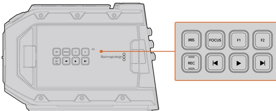
Les boutons de contrôle de la face externe de la Blackmagic URSA Mini vous permettent d'enclencher et d'arrêter l'enregistrement de vos clips, d'activer ou de désactiver le focus peaking et de commuter entre les vues programme ou caméra sur l'écran. Il est également possible de régler l'iris et la mise au point automatique avec un objectif EF.
