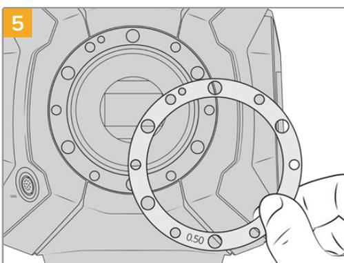
Ajoutez ou retirez des rondelles de 0,10mm, puis réassemblez la caméra jusqu'à trouver le positionnement parfait de vos objectifs. Ajustez à votre convenance, vous pouvez par exemple remplacer la rondelle de 0,50mm par une rondelle de 0,40mm si besoin est.
