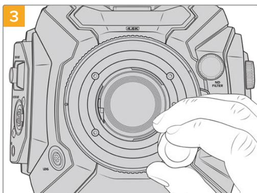
À l'aide d'un tournevis hexadécimal 2mm ou d'une clé dynamométrique réglée sur 0,45Nm, vissez les quatre vis sans trop serrer jusqu'à ce que l'embase de la monture d'objectif touche le boîtier de la caméra.
