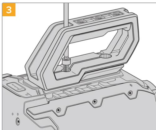
Serrez les vis jusqu'à ce que la poignée soit bien mise en place. Évitez cependant de trop serrer, car cela pourrait endommager les vis.
