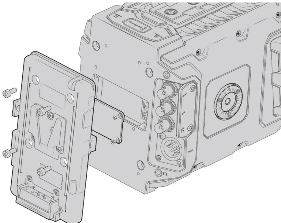
Une fixation tierce vous permet de fixer des batteries V-mount ou gold mount.
