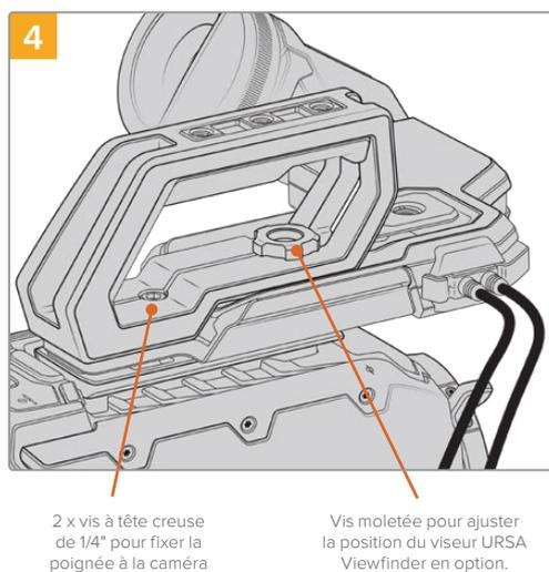
Vissez la poignée sur deux des pas de vis de 1/4" situés sur la face supérieure de la URSA Mini à l'aide des deux vis de 1/4" fournies et de la clé Allen de 3/16". Il est recommandé d'utiliser les deux derniers pas de vis de la URSA Mini dans la plupart des situations, mais vous pouvez choisir la paire de votre choix afin de mieux équilibrer la caméra lorsque vous utilisez de gros objectifs. Évitez cependant de trop serrer, car cela pourrait endommager les vis.
