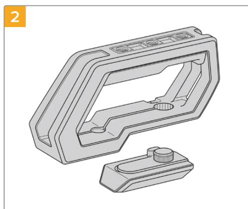
Retirez la protection pour le viseur URSA Viewfinder de la poignée en la soulevant délicatement par le côté et en la faisant glisser hors du trou.
