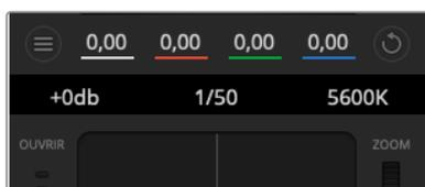
Faites passer le pointeur de votre souris sur les indicateurs de gain, de vitesse d'obturation et de balance des blancs pour faire apparaître les flèches qui vous permettront d'ajuster leurs paramètres respectifs.
