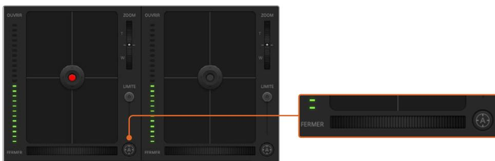
Cliquez sur le bouton de mise au point automatique ou déplacez le curseur de mise au point manuelle vers la gauche ou vers la droite pour effectuer la mise au point d'un objectif compatible.
