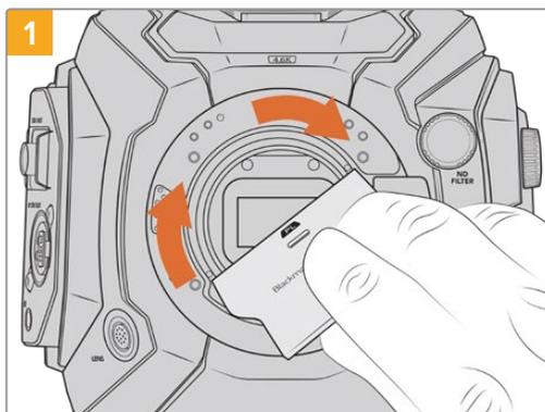
Insérez délicatement le déflecteur PL au centre de la monture d'objectif et tournez avec la main jusqu'à ce qu'il soit assez serré. Utilisez l'embout large de l'outil pour déflecteur afin de resserrer légèrement le déflecteur. Resserrez suffisamment pour que le déflecteur reste en place.
