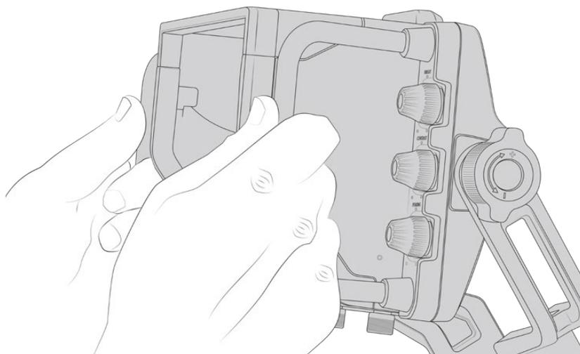
Le support fourni avec le viseur comprend des molettes de tension pour la rotation horizontale et l'inclinaison verticale. De plus, d'autres molettes de tension sont situées de part et d'autre du viseur afin d'obtenir un contrôle encore plus précis.
