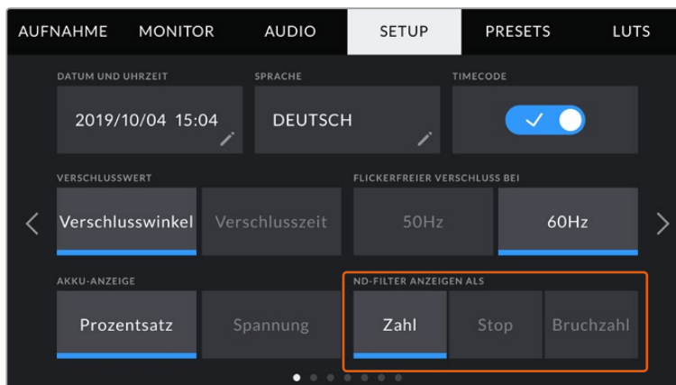
SETUP-Menü der URSA Broadcast mit der Option zum Vorgeben der Darstellungsform von ND-Filterinformationen
