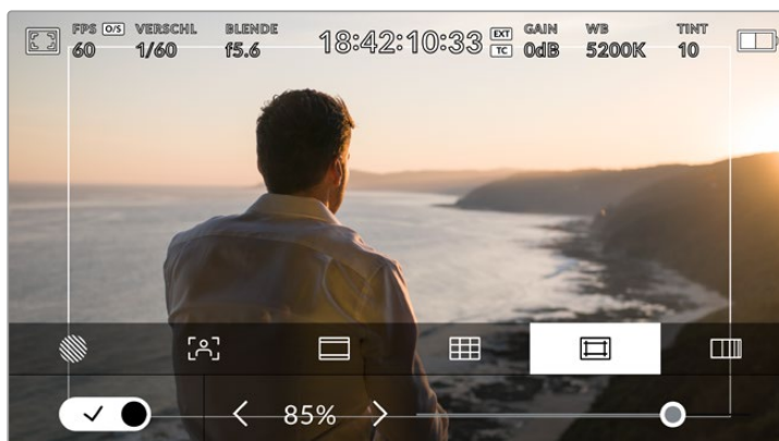
Der Schutzbereich-Indikator ist auf 85 % eingestellt
