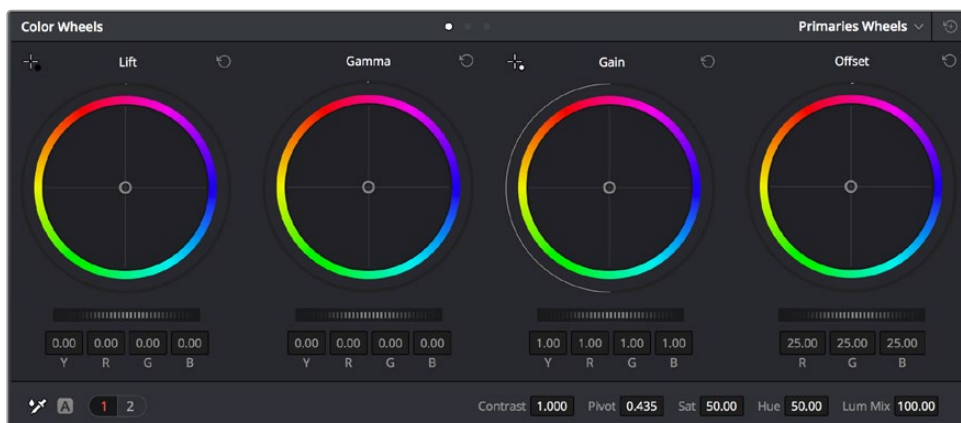
Les roues chromatiques Lift , Gamma , Gain et Offset vous offrent un contrôle complet sur l'équilibre des couleurs et des tons de vos clips. Pour régler toutes les couleurs de façon identique, tournez la roue située sous les roues chromatiques
