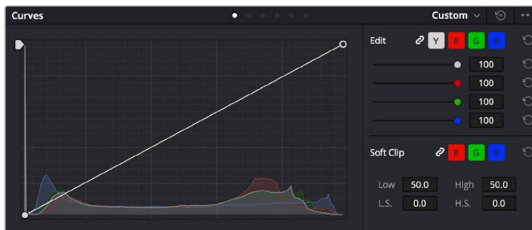
La palette Courbes est un autre outil que vous pouvez utiliser pour faire de la correction colorimétrique primaire ou pour travailler certaines zones du clip avec une Power Window
