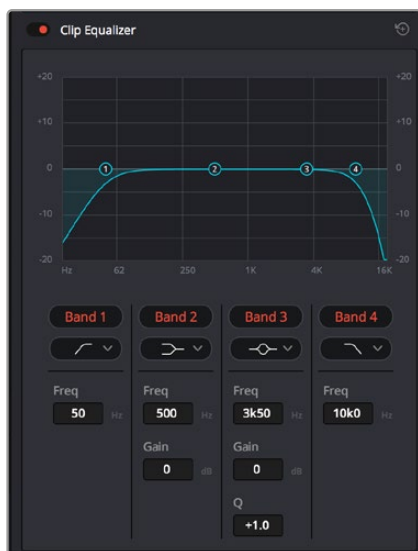
L'égaliseur à quatre bandes peut être appliqué à tous les clips de la timeline
