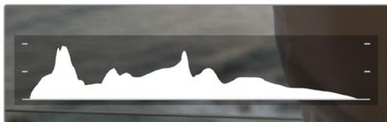
Das Histogramm verschafft Ihnen einen Überblick über die Tonwertspanne zwischen Schatten und Lichtern in Ihrem Clip. Es ist außerdem ein hilfreiches Werkzeug, um die Ausgewogenheit der Belichtung zu überprüfen und sicherzustellen, dass keine Lichter abgeschnitten werden.
