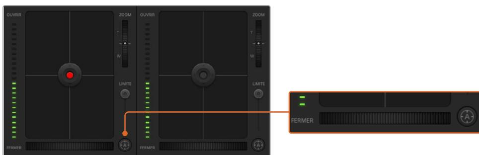
Cliquez sur le bouton de mise au point automatique ou déplacez le curseur de mise au point manuelle vers la gauche ou vers la droite pour effectuer la mise au point d'un objectif compatible.
