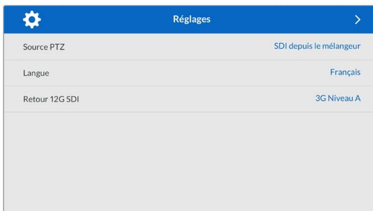
Sélectionnez la source des commandes PTZ en utilisant les réglages de la source PTZ. Vous avez le choix entre **SDI** pour sélectionner les entrées SDI Return in, ou **9 broches** pour le connecteur PTZ à 9 broches situé à l'arrière du Blackmagic Studio Fiber Converter.
