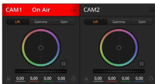
Chaque fenêtre de contrôle de caméra affiche l'état du canal afin que vous sachiez quelle caméra est à l'antenne. Utilisez les roues chromatiques pour ajuster les paramètres Lift, Gamma et Gain de chaque canal YRGB.
