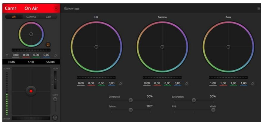
Cliquez sur le bouton DaVinci Resolve pour agrandir la fenêtre de correction colorimétrique et ajuster les paramètres.
