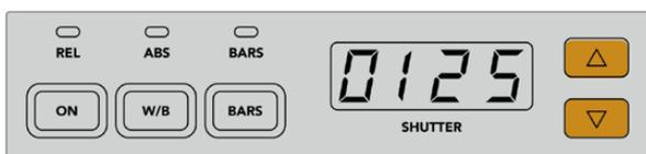
Presione las flechas hacia arriba o abajo para ajustar la velocidad de obturación de la cámara.
