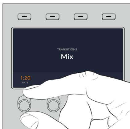
Presione el botón **MIX** y determine la duración de la transición mediante el menú en la pantalla del dispositivo.
