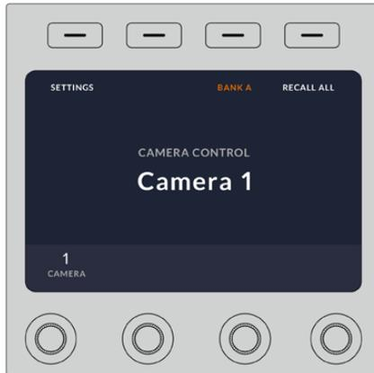
La pantalla de inicio incluye funciones a las que probablemente sea necesario acceder con frecuencia, por ejemplo, para seleccionar el banco deseado o aplicar los ajustes predeterminados a todas las cámaras.
