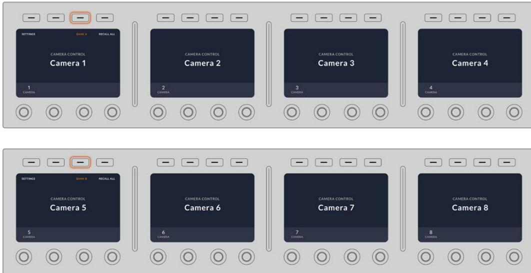
La configuración de bancos permite asignar dos grupos de cámaras a los cuatro módulos y luego alternar de forma inmediata entre ellos presionando el botón **BANCO A/B**.
