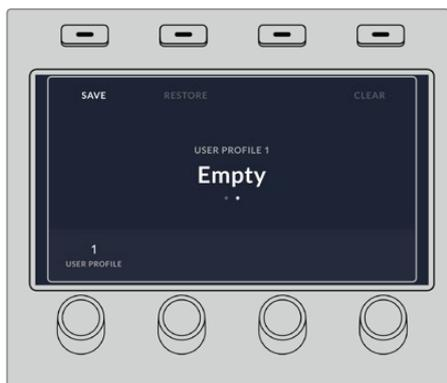
El perfil quedará almacenado en el panel. Para volver a utilizarlo, bastará con seleccionarlo.
