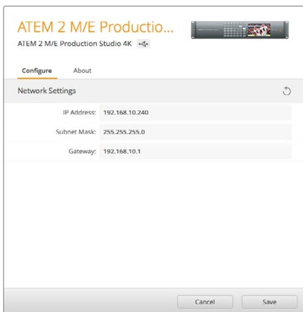
Modifique los ajustes de red mediante la pestaña **Configure** del programa Blackmagic ATEM Setup.
