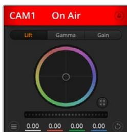
En la parte superior de cada controlador, se indica si la cámara está al aire. Utilice los controles generales debajo de cada círculo cromático para ajustar las luces, los tonos intermedios y las sombras en cada canal YRGB.
