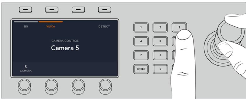
Sélectionnez la caméra que vous souhaitez contrôler et utilisez le joystick pour les fonctions pan, tilt et zoom.
