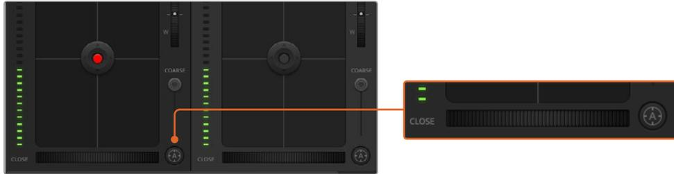
Cliquez sur le bouton de mise au point automatique ou déplacez le curseur de mise au point manuelle vers la gauche ou vers la droite pour effectuer la mise au point d'un objectif compatible.
