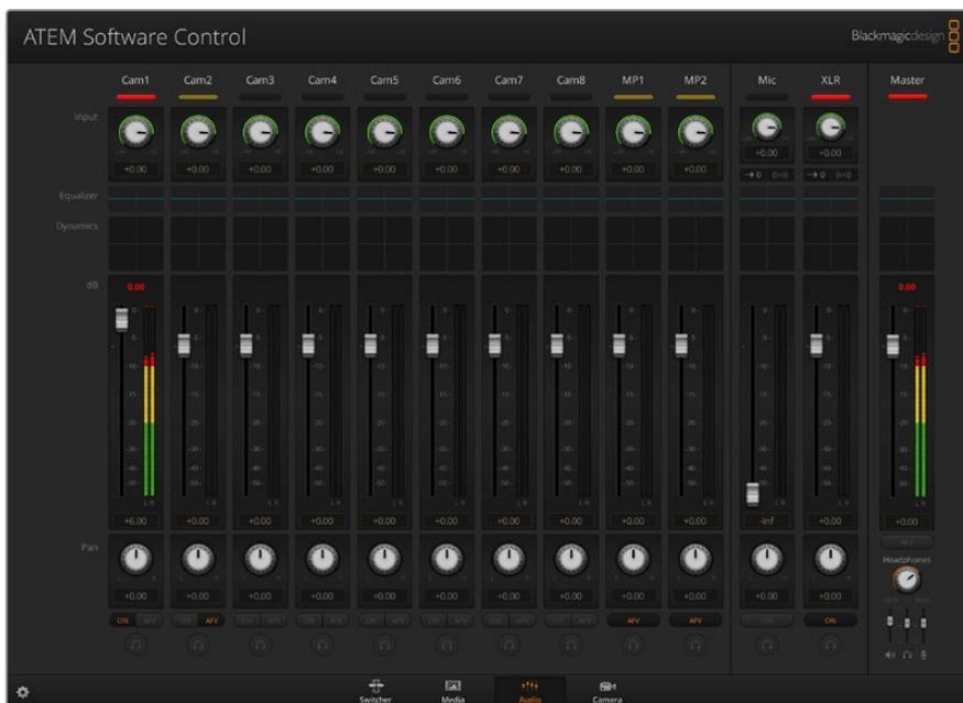
Le mixeur audio affiche des voyants tally pour toutes les sources audio qui sont actuellement à l'antenne ou lorsque la fonction AFV est sélectionnée. Il comporte également les niveaux audio, la balance audio et des boutons permettant de sélectionner l'audio qui doit être utilisé.
