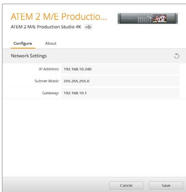
Utilisez l'onglet **Configure** du Blackmagic ATEM Setup pour changer les paramètres réseau.
