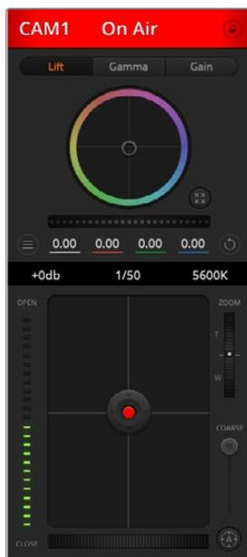
La fonction de contrôle des caméras vous permet de contrôler les caméras Blackmagic à partir de votre mélangeur ATEM.
