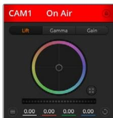
Chaque fenêtre de contrôle de caméra affiche l'état du canal afin que vous sachiez quelle caméra est à l'antenne. Utilisez les roues chromatiques pour ajuster les paramètres Lift, Gamma et Gain de chaque canal YRGB.
