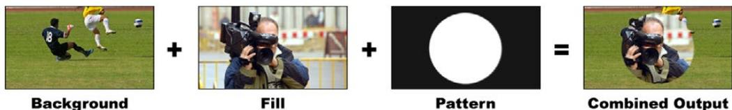
Combiner un arrière-plan avec un signal de remplissage et un motif.
