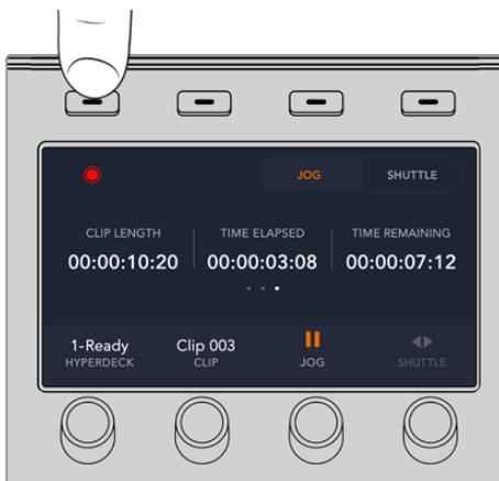
Sur la quatrième page du menu, appuyez sur le bouton d'enregistrement pour enregistrer la sortie programme du mélangeur sur l'HyperDeck. Utilisez les commandes **Jog** et **Shuttle** pour faire défiler les séquences enregistrées.
