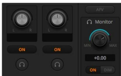
La molette de volume et les boutons du moniteur permettent de régler des niveaux audio indépendants et d'effectuer un contrôle solo du signal de sortie audio.
