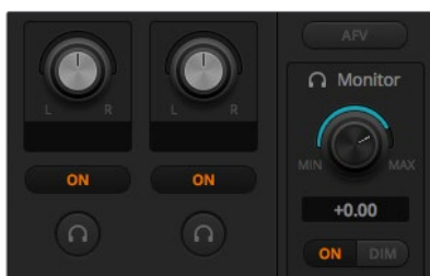
Ручка и кнопки секции Громкость позволяют устанавливать громкость и вести мониторинг отдельных аудиоканалов
