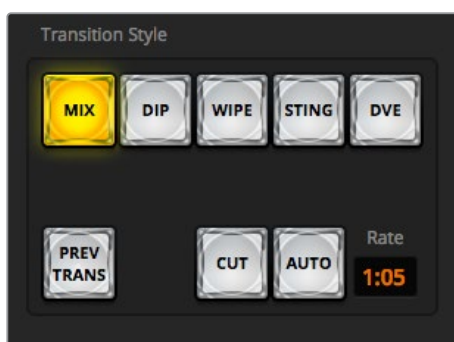
Кнопка AUTO находится в блоке «Вид перехода»
