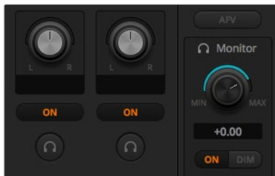
Die Monitorlautstärkeregler und -schaltflächen dienen zur Einstellung separater Audiopegel und erlauben Solo-Monitoring auf dem Audioausgang
