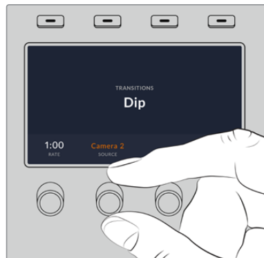
Premi DIP e poi imposta la sorgente e la durata della transizione sul display LCD con le manopole
