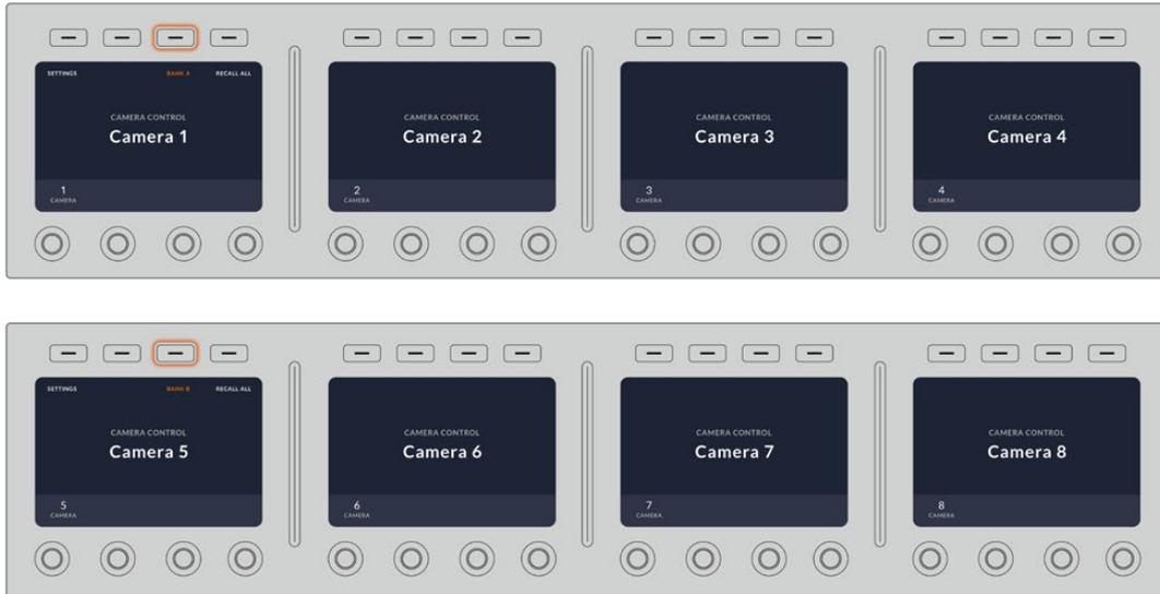
Anhand der BANK-Einstellung lassen sich den vier CCUs je zwei Kamerareihen zuweisen, deren sofortiger Wechsel durch Drücken der Reihen-Multifunktionstaste erfolgt
