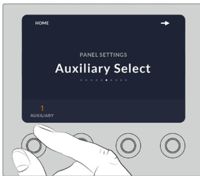
Drehen Sie den Auxiliary-Auswahlregler, um dem Kamerasteuerpult einen spezifischen Auxiliary-Ausgang zuzuweisen
