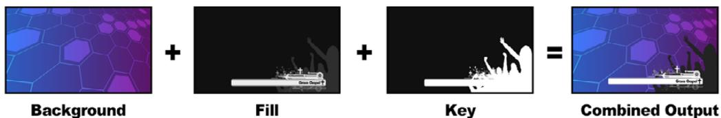
Kombinieren eines Hintergrunds mit Füll- und Stanzsignalen in Form eines Luma-Keys
