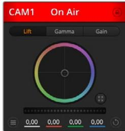
Die Kanalstatus-Box in jedem Kamerabedienfeld zeigt an, welche Kamera sich auf Sendung befindet. Benutzen Sie die unter den Farbrädern befindlichen Masterräder, um die „Lift“-, „Gamma“- und „Gain“-Steuerungen für jeden YRGB-Kanal individuell anzupassen
