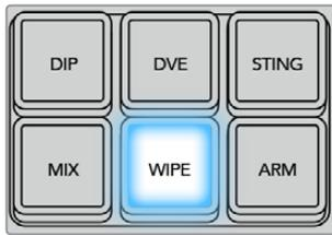
Drücken Sie in der Quellauswahlzeile eine Quelltaste, um eine Quelle für den Rand der Wischblende vorzugeben. Wählen Sie bei festgehaltener SHIFT-Taste eine geschiftete Quelle aus, bspw. einen Farbgenerator oder Media Player
