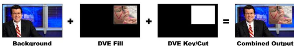
Kombinieren eines Hintergrundbilds mit DVE-Füll- und DVE-Key/Stanzsignal
