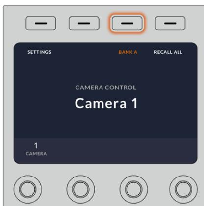
Durch Drücken der BANK-Multifunktionstaste wechseln Sie zwischen Kamerareihe A und B. Durch Gedrückthalten der Taste schalten Sie eine Kamerareihe ein oder aus
