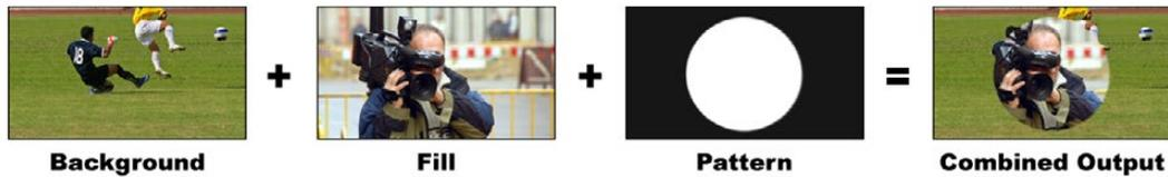
Kombinieren eines Hintergrunds mit Füllsignal und Muster-Key
