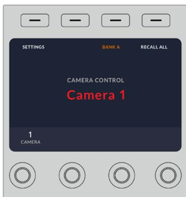
An dem auf der LCD-Startseite eingeblendeten Kameranamen bzw. an der Kameranummer ist zu erkennen, welche Kamera aktuell für eine CCU ausgewählt ist
