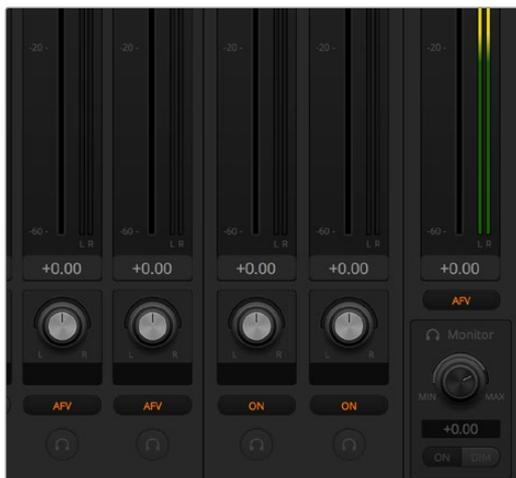
Beim Betrieb eines 2 M/E oder 4 M/E ATEM Mischers bedeuten ausgegraute Solo- und Monitoreinstellungen, dass für die Audioausgabe im Einstellungen-Fenster die Option Programm-Audio aktiviert ist
