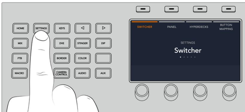
Das ATEM Advanced Panel zeigt Ihnen am oberen Rand des LCD-Bildschirms folgende vier Einstellungsoptionen an: MISCHER, PANEL, HYPERDECKS und TASTENBELEGUNG. Diese Optionen stehen jeweils für ein Einrichtungsmenü. Drücken Sie die LCD-Multifunktionstaste über der Display-Anzeige „HyperDecks“, um das HyperDeck Einstellungsmenü zu öffnen.
