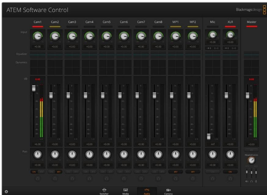
Der Audiomixer zeigt Tally-Rotlichter für alle aktuell on air befindlichen Audioquellen an und bei aktiviertem AFV zusätzlich Audiopegel, Lautstärke sowie Schaltflächen zur Auswahl des zu benutzenden Tons
