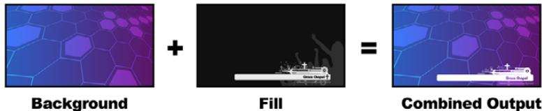
Kombinieren eines Hintergrunds mit Füll- und Stanzsignalen in Form eines Luma-Keys
