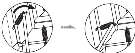
Sobald alle vier Ecken mit jeweils zwei Federn befestigt sind, setzen Sie mittig jeder Länge eine Feder. Bitte beachten Sie auch hier, dass Sie immer zuerst die gegenüberliegende Seite befestigen und erst danach zu einem anderen Punkt übergehen.
