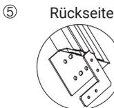
6. Anschließend können die bereits zusammengebauten horizontalen Rahmenprofile (A) mit den vertikalen Profilen (B) verbunden werden.
