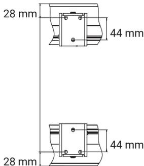
3. Hängen Sie anschließend die Rahmenleinwand an Ihre Wand und achten darauf, dass die (oberen) Winkel in die vorgesehene Nut des Rahmens greifen.
