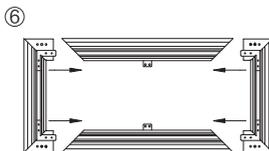
7. Fixieren Sie den Rahmen, indem Sie die Schraube (Q) vier Mal in jeden L-Winkel einschrauben. Achten Sie darauf, dass Sie sobald ein Winkel fest ist, erst den schräg gegenüberliegenden Winkel fixieren.
