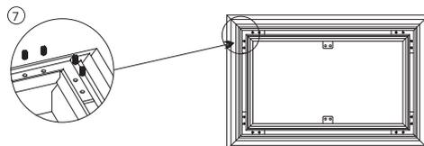
8. Setzen Sie die Stützstrebe (L) mittig der Länge in den Rahmen ein (gemäß Abb. 8) und fixieren diese mit den beiliegenden Schrauben am Rahmen.
