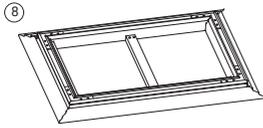
9. Drehen Sie den montierten Rahmen um, sodass die Verbindungselemente (J) oben liegen. Schrauben Sie die restlichen Schrauben (O) in die Verbindungselemente und ziehen diese fest. Achten Sie darauf, dass Sie auch hier immer die gegenüberliegende Seite zuerst festziehen. Anschließend fixieren Sie die innen-liegenden Schrauben mit dem Inbus (S).
