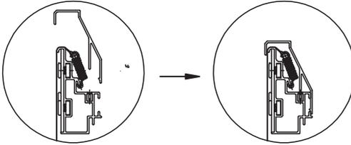
3. Stecken Sie nun die Eckverbinder (E) in die Enden der Cover-Rahmen und setzen anschließend die vertikalen Cover-Rahmen (D) auf die kurzen Rahmenseiten auf.
