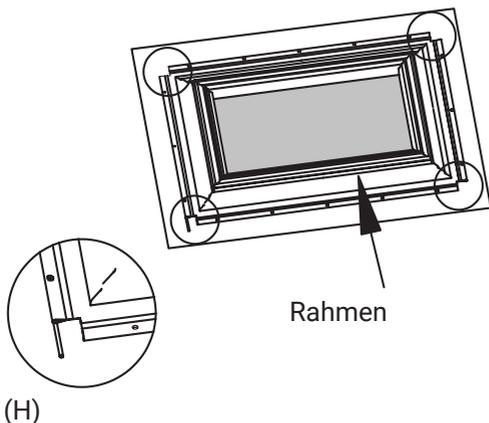
3. Nutzen Sie das Spannwerkzeug (T) und die Spannfedern (M) um das Projektionstuch an den Rahmen zu befestigen. Beginnen Sie an den 4 Ecken die Spannfedern an den Spannstangen einzuhaken und ziehen mit dem Spannwerkzeug die Federn an die dafür vorgesehene Nut des Rahmens.
