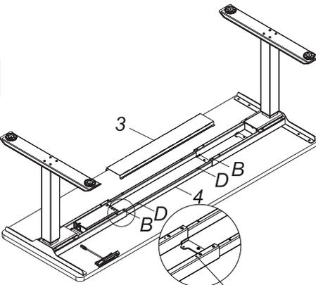
Installieren Sie die Kabelmanagement-Platte (3) wie in Schritt 6 Methode 1 erklärt.
