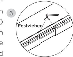
Schrauben Sie zu Beginn die Schraube (B) in die Stützstrebe, jedoch ziehen Sie diese nicht fest an. Schieben Sie anschließend die Kabelmanagement-Platte (3) erst auf einer Seite unter die Schrauben (B) und dann schieben anschließend die andere Seite unter die Schrauben auf der gegenüberliegenden Seite. Sobald die Platte unter den Schrauben positioniert ist, können die Schrauben (B) mit dem Inbus (F) vollständig fest-gezogen werden.
