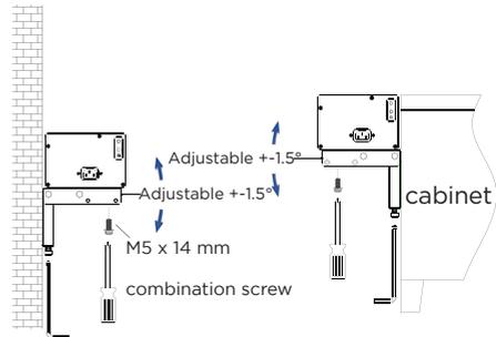
Nachdem die Leinwand nun am finalen Platz auf den Winkeln installiert ist, schließen Sie die Stromversorgung an der Leinwand an und fahren das Tuch komplett aus. Prüfen Sie nun den Winkel zwischen dem Tuch und Ihrer Wand und nutzen den Inbusschlüssel, um die Einstellschrauben an den beiden L-Winkeln zu verstellen, bis das Tuch optimal gerade und parallel zur Wand ausgerichtet ist. Dabei können Sie bis zu  $\pm 1,5^\circ$  die Winkel anpassen (Abb. 2).
