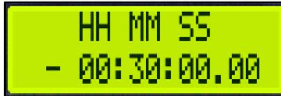
Bei dieser Einstellung wird die Explo-Show nicht bei **00:01:00.00** starten, sondern mit einem Versatz von **-00:30:00.00**, sprich 30 Minuten früher. Das Beispiel rechnerisch dargestellt:
