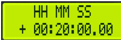
Bei dieser Einstellung wird bei dem ausgegebenen MIDI Time Code ein Versatz von **+00:20:00.00**, sprich 20 Minuten aufgerechnet. Das Beispiel rechnerisch dargestellt:
