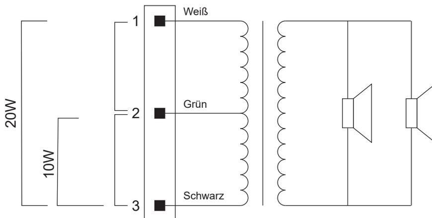
Ausgangsleistung und Impedanz des CLS220-Säulenlautsprechers hängt von der Verkabelung ab. Die Ausgangsleistung kann je nach angeschlossenen Kabeln zwischen 10 und 20 W bei 100 V liegen. Siehe obenstehende Darstellung.
