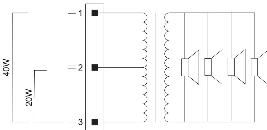
Ausgangsleistung und Impedanz des CLS440-Säulenlautsprechers hängt von der Verkabelung ab.
