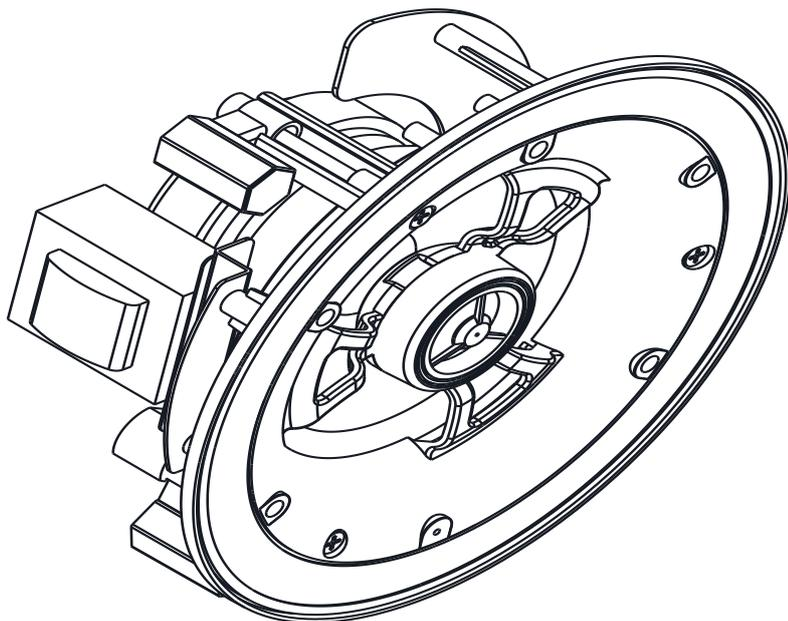
Deckeneinbau-Lautsprecher für 100-V- und 8-Ohm-Verstärker. Lautsprecher mit zwei Frequenzbereichen mit passiver Frequenzweiche. Unsichtbare Kantengestaltung mit Magnetgitter.
