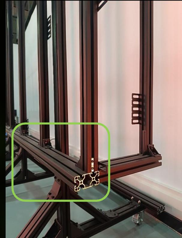
1. Le strutture in alluminio devono essere fissate saldamente a un supporto a terra o alla parete portante.
