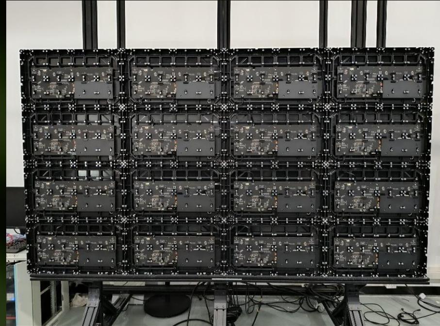
1. Dopo aver completato il montaggio di tutti i cabinet del display secondo le fasi precedenti, assicurarsi che: tutti i cabinet siano installati correttamente; l'allineamento tra i cabinet sia stato verificato e risulti conforme; le viti dei connettori frontali e delle piastre di montaggio siano ben serrate; i cabinet siano saldamente fissati alla struttura in acciaio.
