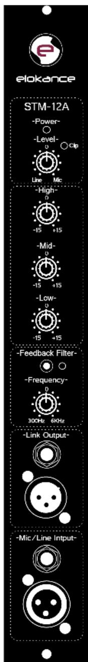
Vérifiez que le potentiomètre «**LEVEL**» est à 0 avant de connecter votre signal d'entrée. Les STM possèdent 2 entrées séparées acceptant les signaux symétriques et asymétriques provenant de votre table de mixage. N'utilisez qu'une des 2 entrées au choix. Il est conseillé d'utiliser un cordon micro (XLR/XLR) transportant un signal symétrique pour plus de fiabilité.
