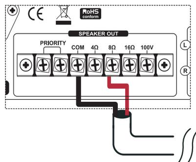
Lorsque vous raccordez vos haut-parleurs à l'amplificateur prenez garde de respecter les polarités. Raccordez les haut-parleurs équipés de transformateurs aux bornes **COM** et **8 Ω** de l'amplificateur.
