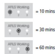
Pour les utilisateurs mal voyants, le PL1 émet un bip de fréquence par étape pour aider à la sélection (bas : 10 minutes/ moyen : 30 minutes / haut : 60 minutes).
