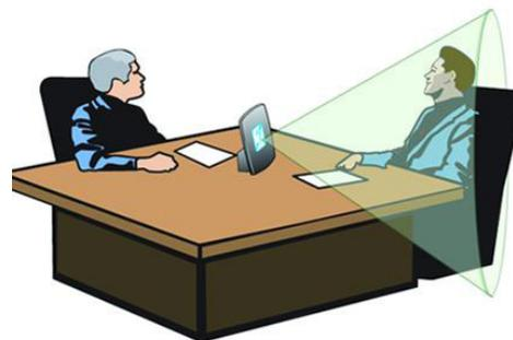
Il est important de ne pas positionner l'amplificateur directement devant soi afin de voir les gens dans des chaises roulantes etc. Positionner l'amplificateur de telle sorte que sa face avant soit orientée vers l'utilisateur appareillé sans bloquer sa vue. Le microphone à l'arrière de l'ampli a une large portée et réagit à la prise de parole si positionné comme montré ci-dessus.
