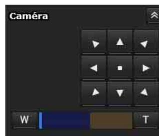
À l'aide du panneau de commande, vous pouvez utiliser le panoramique ou l'inclinaison, passer à la position initiale, effectuer un zoom et la mise au point de la caméra pour l'image de contrôle actuellement affichée.
