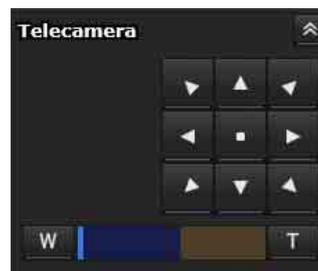
È possibile utilizzare pan/tilt, spostarsi alla posizione iniziale, effettuare operazioni di zoom e messa a fuoco della telecamera mediante il pannello di controllo dell'immagine del monitor correntemente visualizzata.
