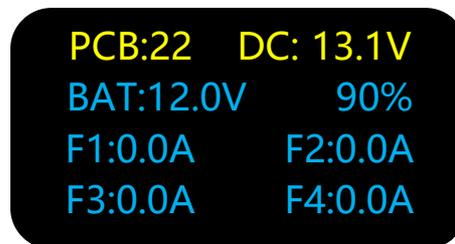
**Prima riga:** Monitoraggio temperatura PCB, tensione CC
