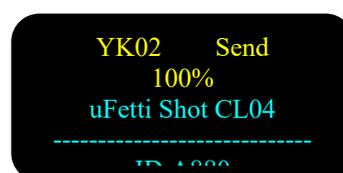
**Prima riga:** mostra l'utilizzo del modulo wireless a distanza e la tensione della batteria, mentre quando si invia il segnale viene visualizzato "send"
