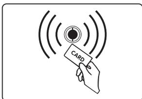
La scheda RFID viene fornita insieme alla HC8200. Si tratta di un dispositivo di sicurezza che consente alla macchina di identificare i parametri e i tipi di materiale di consumo.
