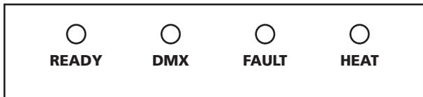
**READY:** Il lampeggiamento indica il riscaldamento, circa 5 minuti. Il passaggio da lampeggiante a acceso a lungo indica che la macchina è pronta a funzionare.
