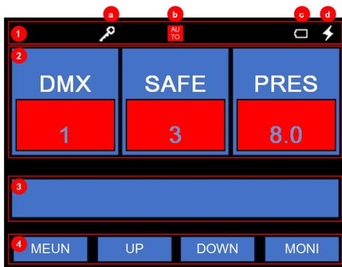
1. Barra di stato, 4 icone possono essere visualizzate nella barra di stato.
